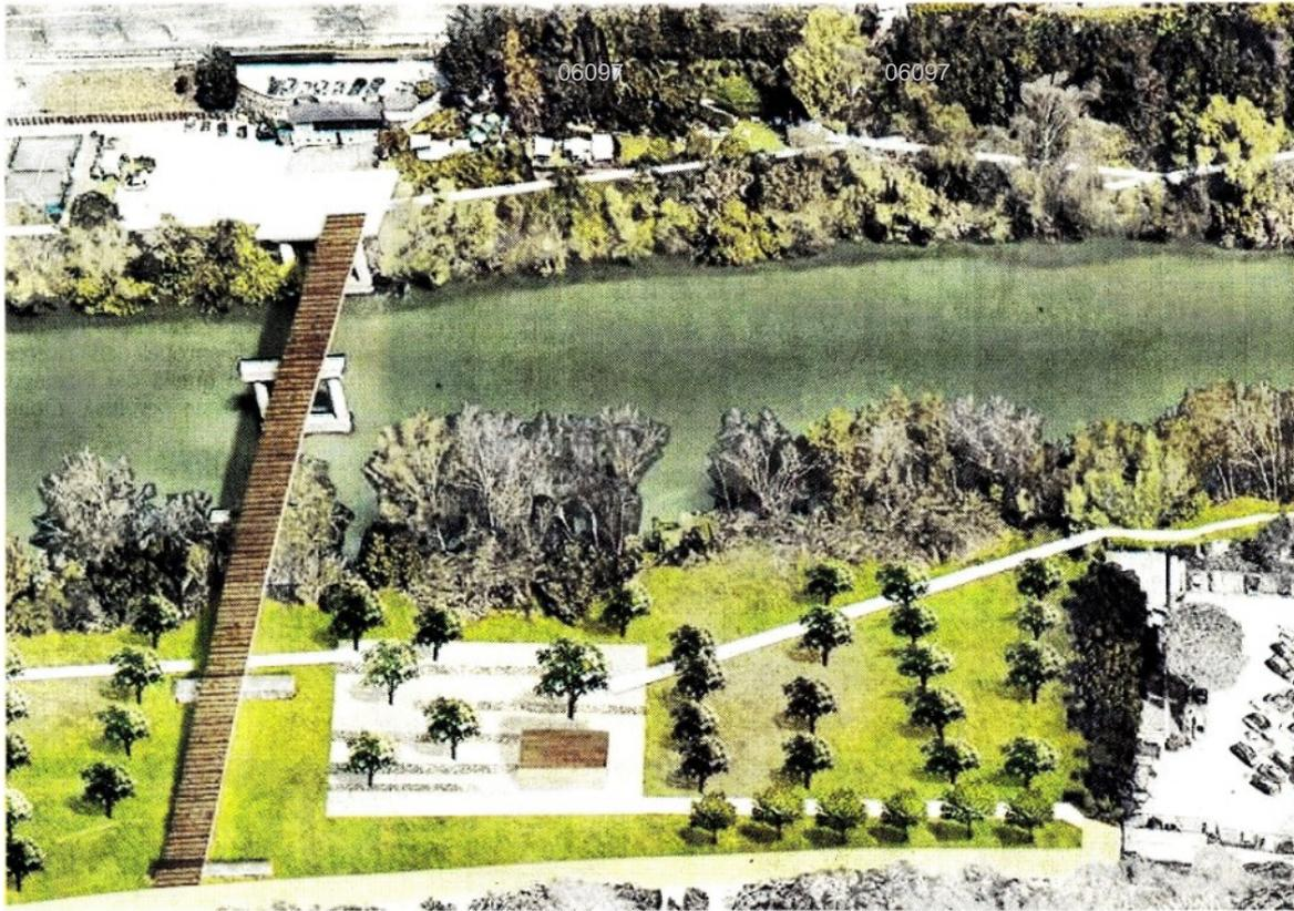
Il rendering di ponte Bailey, struttura diffusa soprattutto in ambito bellico in quanto montabile e smontabile in poco tempo: fu realizzato nel 1962 quando ponte Flaminio venne chiuso per il cedimento di un pilone. Riaperto nel 1964, il ponte Bailey perse la sua funzione di "supplente" e intorno alla fine degli anni '60 venne rimosso
